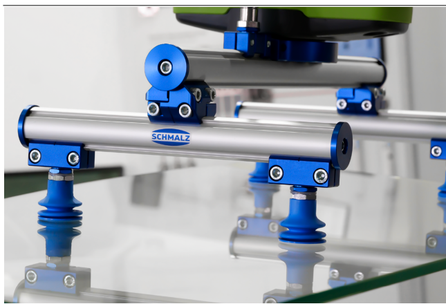
Le système de préhenseur modulaire PXT lors de la manipulation d'une feuille de verre
